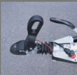
Sicherheitskupplung mit Spurstabilisierung
