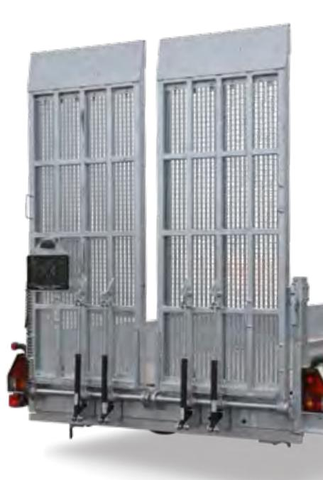
Einteilige, breite Rampen mit Stahlgitterrost
