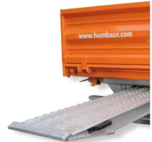
2 Aluminium-Rampen, unter der Ladefläche einschiebbar
