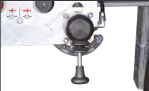
Luftfederung mit Heben/Senken Funktion
