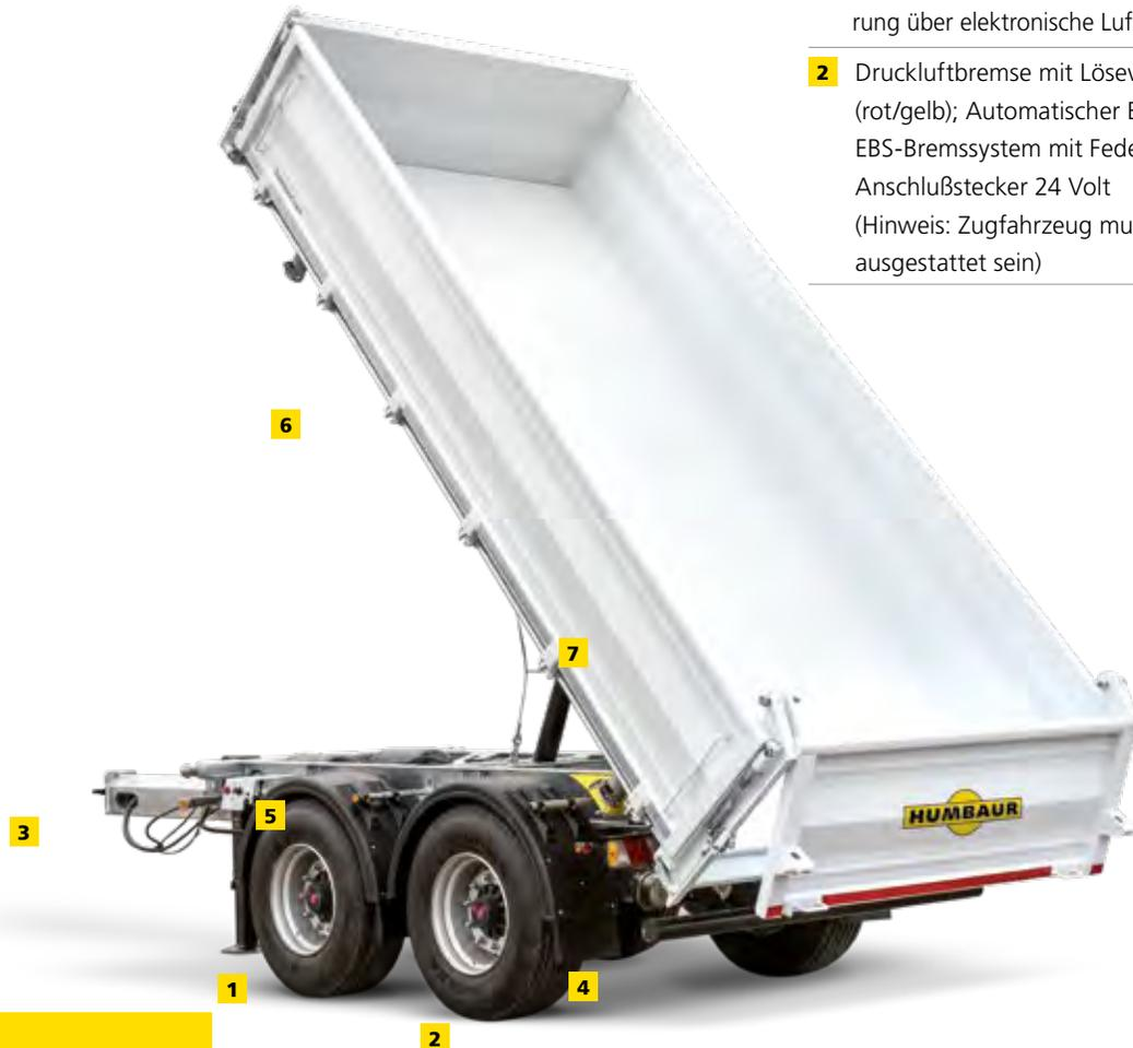
**1** Verstärkte SAF CD Achsen mit Trommelbremse; Kippstabilisierung über elektronische Luftfederung mit Stoßdämpfern
