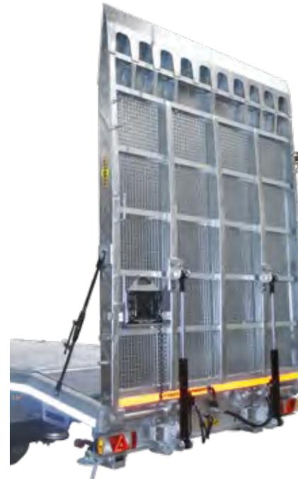
Hydraulische Überfahrwand mit Stahlgitterrost
