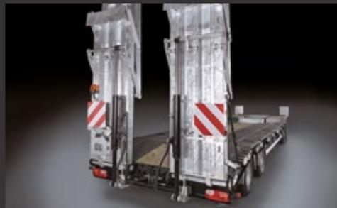
2-teilige hydraulische Rampen mit hydraulischer Seitenverschiebung
