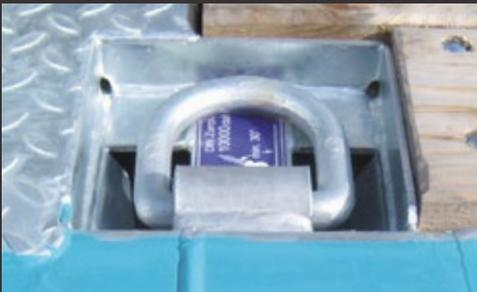
Zusätzlicher im Brückenboden versenkter Zurrpunkt
