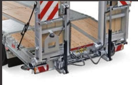
1-teilige hydraulische Rampen mit hydraulischer Seitenverschiebung
